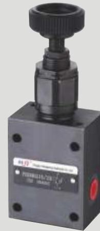
PBD 型溢流阀是直动式座阀，用以限制系统压力，其结构可分为锥阀（压力至 40Mpa）和球阀结构，压力等级分别为 2.5；5；10；20；31.5；40。
